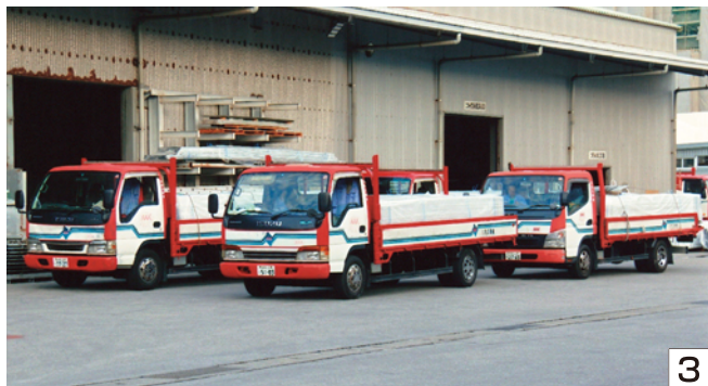
3 3トン車4台で現場配達です。 ダンネツイーナミ長さ 5,200mm×250 枚を 運搬します。
