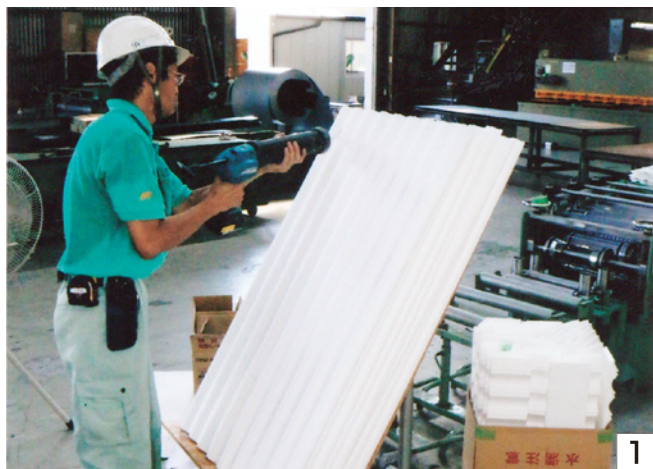
1 接着剤の塗布作業です。
