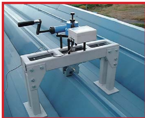
風圧(風荷重)に対する現場試験 *試験機の貸し出しサービスを行っております。
