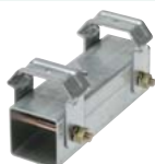
棟用タイトフレーム 板厚:2.3mm(亜鉛鉄板) (受注生産品) ★対応勾配:30/100以下
