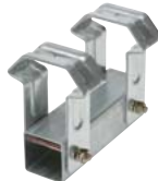
棟用タイトフレーム(切妻用) 板厚:3.2mm(亜鉛鉄板) ★対応勾配:30/100以下
