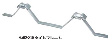
勾配2連タイトフレーム 板厚:3.2mm(亜鉛鉄板) ★対応勾配:5/100~20/100
